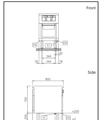
Electrical inlet (power) EQ Equipotential screw
